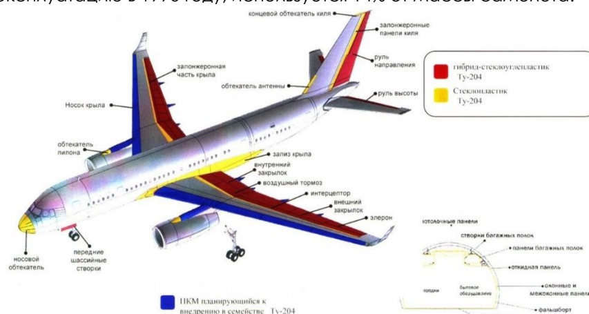
Рисунок 2 - Распределение материалов конструкции Ту-204
