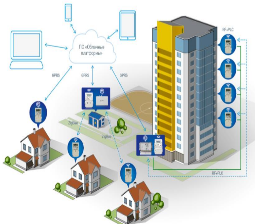
Рисунок 1 – Организация связи АСКУЭ АО "Энергомера"
